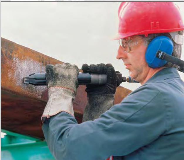
Ingersoll Rand lékgalapácsok kialakítása ipari szabvánnyá érett – az edzett fej az extrém körülményeket is jól türi – a hosszított orr a túrtartó élettartamát növeli. Vésőkalapács és tűskalapács kivitelben is szállítható.
